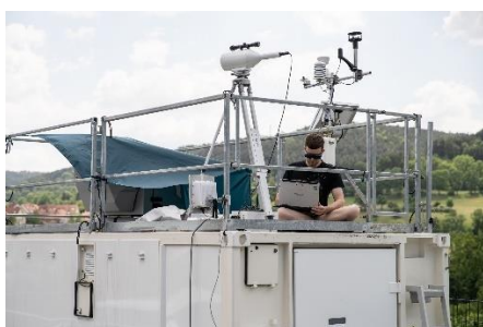
Auf dem Dach des QuBUS, der auf dem Gelände des Fraunhofer IOF steht, empfindet sich die Einheit zum Empfang der Quantenschlüssel, die via Freistrahllink von den Stadtwerken Jena geschickt werden. © Fraunhofer IOF
